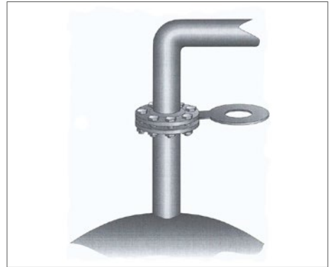
Abb. 18 Abtrennen mittels Steckscheibe
