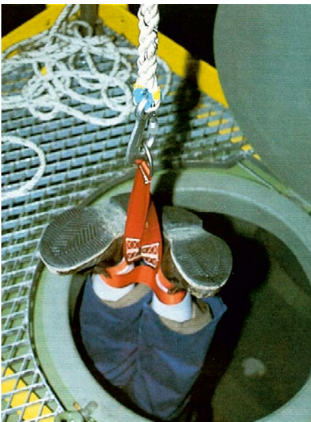
Abb. 28 Rettungsschleufe (besonders geeignet zum schnellen Retten, z. B. wenn die Person kei- nen Auffanggurt trägt und Lebensgefahr durch Sauerstoffmangel oder Gefahrstoffe besteht)
