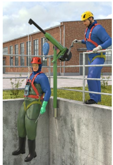
Abb. 25 Zugang mittels Winde zur Personen- beförderung und Auffanggurt
